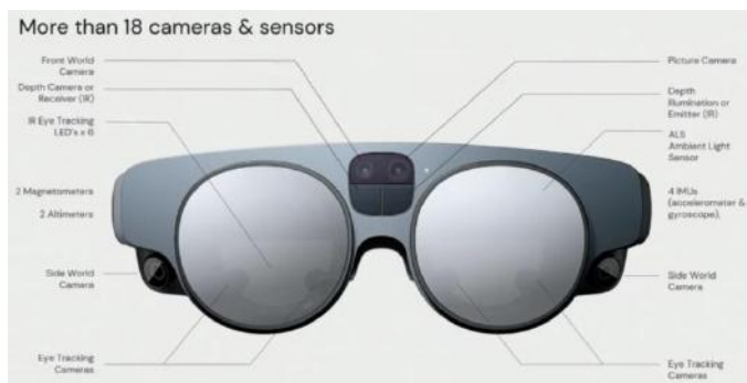
图 75: Magic Leap 2 搭载 18 个传感器，其中含 9 个摄像头
