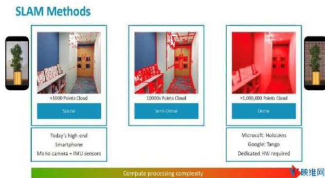
图 78：SLAM 捕捉 3D 特征点（点云）越多，渲染效果越真实
