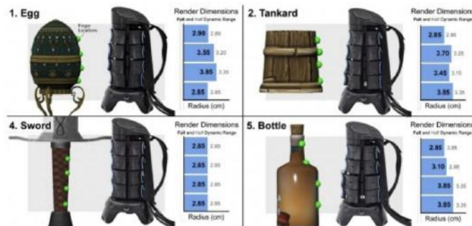
图 41: 微软 VR 手柄通过控制各模块力度, 模拟抓握物体触感
